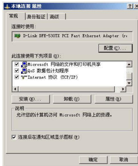
我们选择“常规”页面下的“此连接使用下列项目(D):”的“Internet(TCP/IP)”项。点击属性弹出如图所示的窗口。
